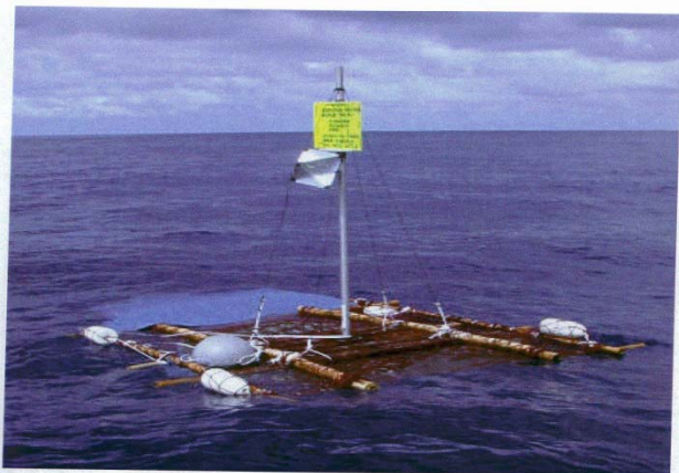
Figure 2-2 : DCP expérimental utilisé par l'Ifremer dans le cadre de cette étude.
