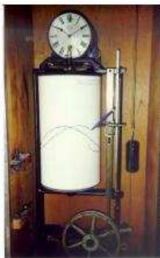
Fig 1.4. Mareógrafo histórico del IEO (Foto: Joaquín Molinero).
