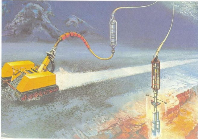
Oben: Methoden zum Erzabbau am Meeresboden. Links: System zum Aufsammeln von Manganknollen. Rechts: System zum Aufsaugen von Erzschlamm
